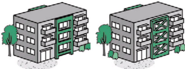
フレーム架構補強
